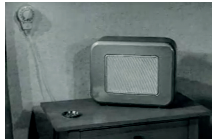
Still uit een bedrijfsfilm van de PTT over de radiodistributie. Een opstelling als deze was in veel Nederlandse huishoudens te vinden.
