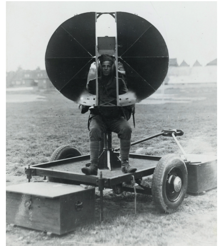
Eind jaren ‘20, begin jaren ‘30 van de vorige eeuw ontwierp onderzoeker ir. J.L. van Soest van de Commissie voor Fysische Strijdmiddelen, de voorloper van het huidige TNO, het zogenoemde Luistertoestel waarmee het mogelijk was vliegtuigen tot op 5 kilometer letterlijk te horen aankomen. Alleen sommige militaire eenheden beschikten over een Luistertoestel. (Foto collectie NIMH)
